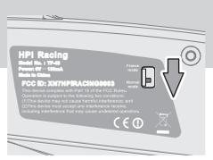
При использовании передатчика во Франции установите переключатель в положение «France mode»
