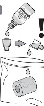
Используйте один колпачок масла для воздушных фильтров
