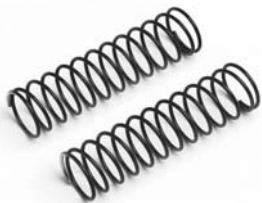
86912 13x57x1.1мм 10витков (3.6LB,красный) 86913 13x57x1.1мм 11витков (3.3LB,белый) 86914 13x57x1.1мм 12витков (3.0LB,розовый) 86915 13x57x1.1мм 13Свитков (2.7LB,серебро) Пружина амортизатора
